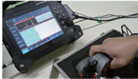
CFRP (delamination depth 0.3mm-4.7mm)
