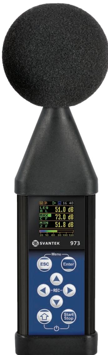
L'**enregistrement de l'historique temporel** des résultats tels que Leq, Max, Min et Crête est réalisé sur la mémoire intégrée de 8 GB.
