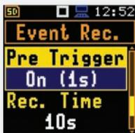
**L'ENREGISTREMENT AUDIO** synchronisé avec l'historique temporel peut ensuite être ouvert et rejoué avec le logiciel Supervisor rendant ainsi possible la reconnaissance de source. L'enregistrement audio est programmable et peut être déclenché sur niveau seuil. La durée d'enregistrement est également paramétrable. Cette option peut être activée après acquisition d'un code licence.
