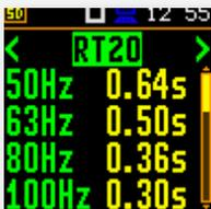
**DUREE DE REVERBERATION TR60** permet le calcul de durée de réverbération en bandes 1/1 octave (de 63 Hz à 8 kHz) ou 1/3-octave (de 50 Hz à 10 kHz) et 3 niveaux globaux (pondérés A, C et Z). Le process de mesure et de calcul implémenté dans le SV 973 répond aux exigences de la norme ISO 3382. Cette option peut être activée après acquisition d'un code licence.
