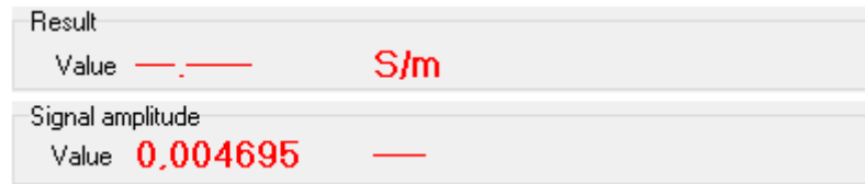
Figure 12 – L’affichage de l’amplitude du signal est actif, mais pas celui de la conductivité électrique quand la sonde est loin de la cible
