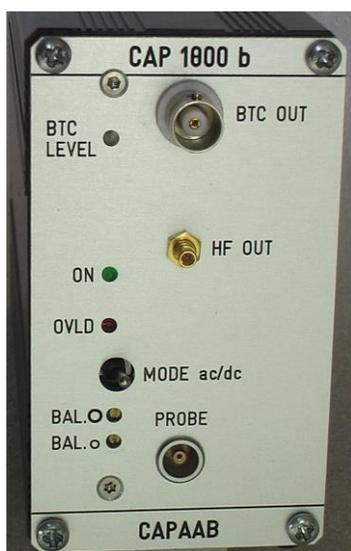
**Gamme de mesure :** de 0→1 mm à de 0→12 mm selon le diamètre de l'électrode de mesure du capteur pseudo triaxial associé (\*)
