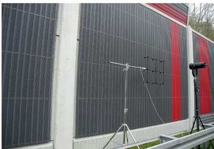
En soustrayant l'une de l'autre les deux réponses impulsionnelles calculées on pourra ainsi déterminer le coefficient d'absorption acoustique et l'indice de réflexion acoustique de l'échantillon de mur à caractériser.
